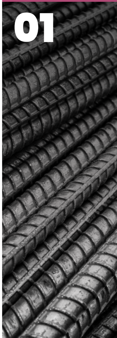
حديد التسليح المجدول Rebar Steel
